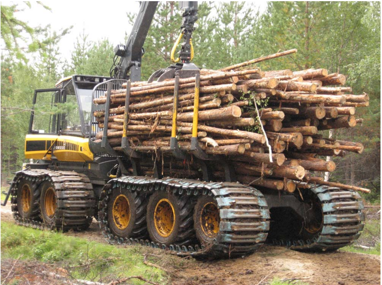
Kuva 1. Projektissa ideoitiin apupyöräratkaisu telissä olevalle telalle. Ajatuksena oli, että apupyörät tulisivat telin etupuolelle heti keskinivelen jälkeen. Suunnittelussa päädyttiin kuitenkin ratkaisuun, jossa ne ovat erillisessä, traktorin takaosaan kiinnitetyssä rungossa. Ratkaisu toimi ja pikakiinnityksen ansiosta lisävarusteajattelu toteutuu hyvin. (kuva Sami Lamminen)
