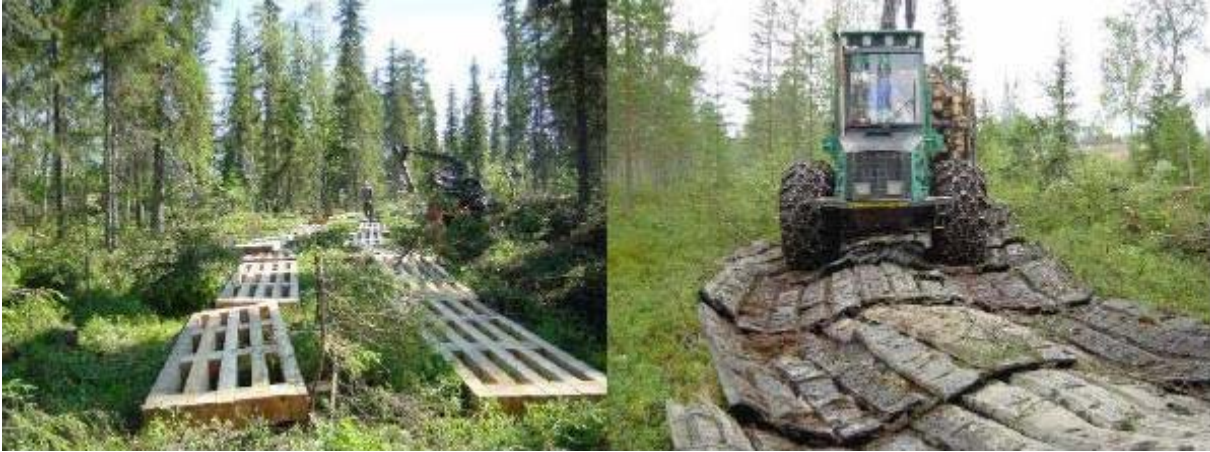
Kuva 7. Maailmalla on paljon kokeiltu erilaisia ajoalustan vahvistamisratkaisuja. 1990 -luvun loppupuolella puhuttiin Ruotsissa paljon korjuuketjun mukana kulkevista siirrettävistä pitkospuista (Markskonaren Alf). Vuonna 2000 myös Metsähallitus tutki pitkospuiden, rengasmattojen ja havituksen käyttöä ajoalustan vahvistamisessa. (kuvat Kari Lassila)
