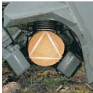
Stammen mäts ytterst noggrant med en tre-punktsmätning som också beaktar eventuell oval form på stammen.
