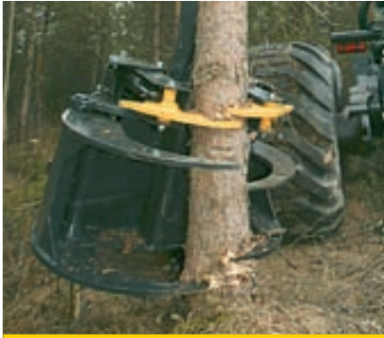
1. Katkaisuvaiheessa kahmari tarttuu puuhun kiinni ja giljotiini katkaisee sen.
