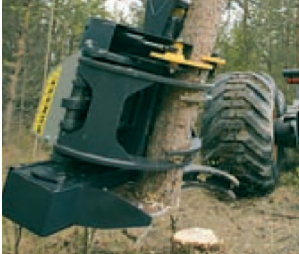
2. Katkaisuliikkeen yhteydessä puu siirtyy automaattisesti keräilypihtien otteeseen.
